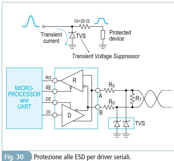
Fig. 30 Protezione alle ESD per driver seriali.
