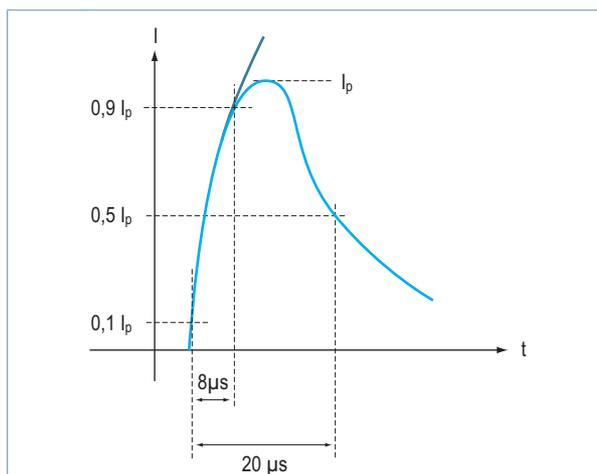
Fig. 14 Impulso di corrente  $8/20 \mu\text{s}$ .
