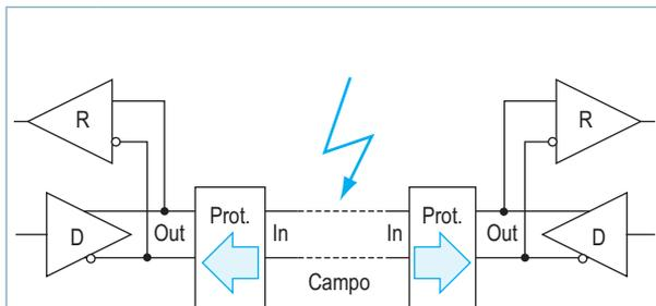
Fig. 17 Disposizione in campo dei dispositivi di protezione.
