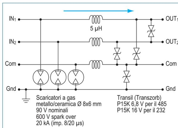
Fig. 9 Struttura di un dispositivo di protezione per linee dati.
