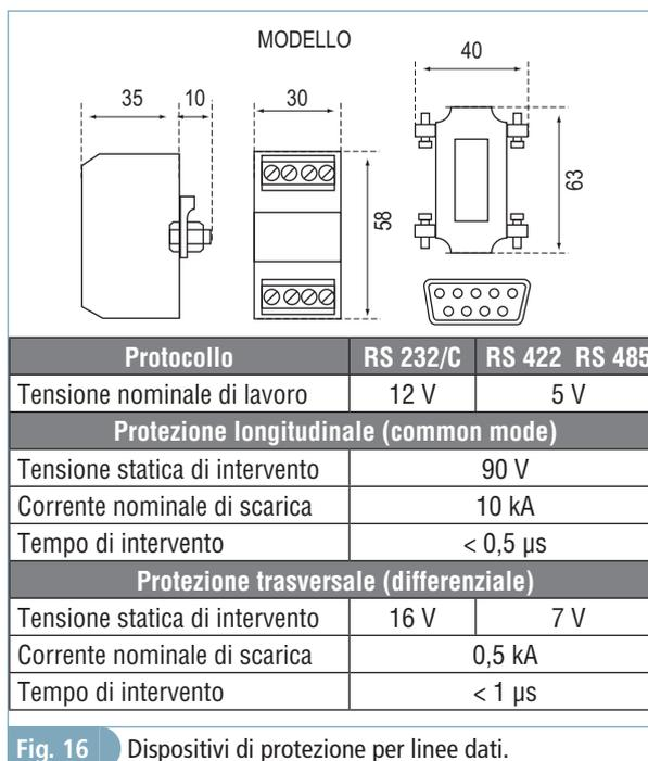
Fig. 16 Dispositivi di protezione per linee dati.
