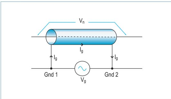
Fig. 5 Loop di corrente nello schermo dovuto a differenze nelle tensioni di terra.
