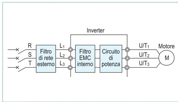
Fig. 21 Filtro di rete esterno e filtro EMC interno.
