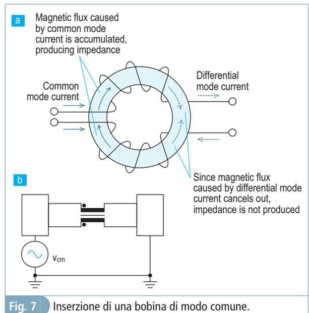
Fig. 7 Inserzione di una bobina di modo comune.
