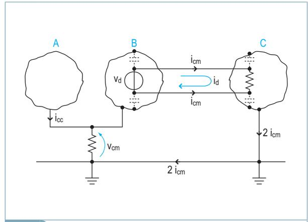
Fig. 6 Collegamento corretto dello schermo per cavi lunghi.
