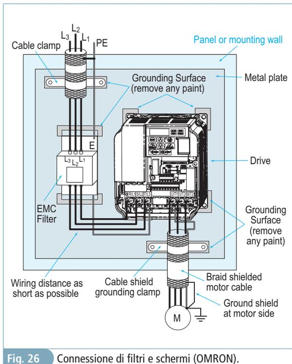
Fig. 26 Connessione di filtri e schermi (OMRON).
