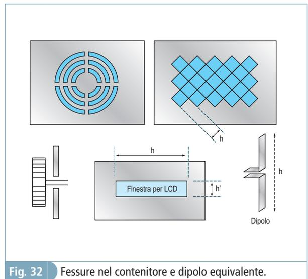
Fig. 32 Fessure nel contenitore e dipolo equivalente.
