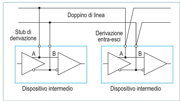
**Fig. 3** Stub di derivazione e derivazione entra-esce.
