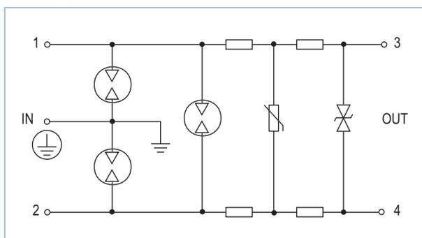
Fig. 13 Rete di protezione a tre livelli.
