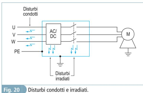
Fig. 20 Disturbi condotti e irradiati.
