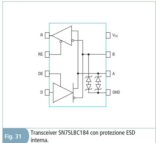
Fig. 31 Transceiver SN75LBC184 con protezione ESD interna.
