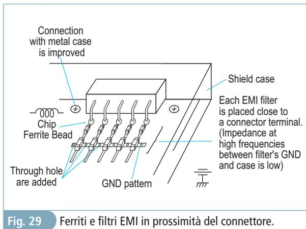
Fig. 29 Ferriti e filtri EMI in prossimità del connettore.
