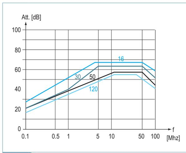
Fig. 23 Attenuazione del filtro di rete.
