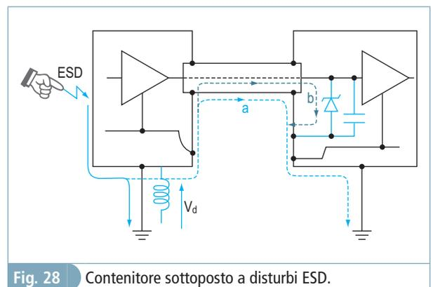
Fig. 28 Contenitore sottoposto a disturbi ESD.
