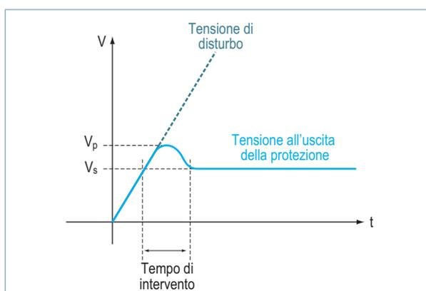
Fig. 15 Andamento della risposta di una protezione.
