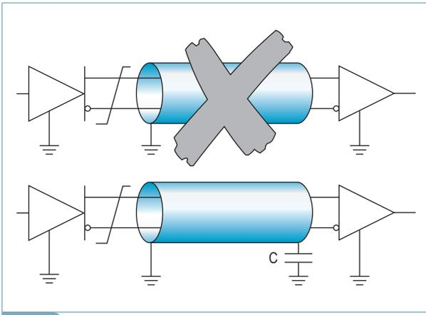
Fig. 4 Collegamento corretto dello schermo per cavi lunghi.
