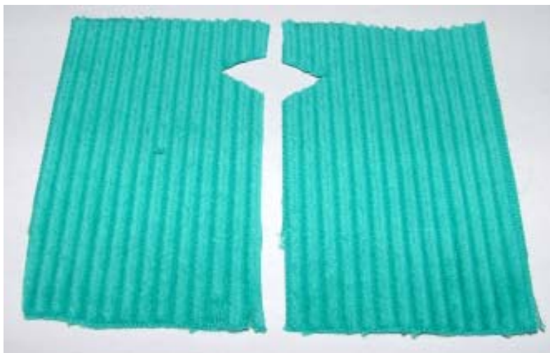
Velluto con pelo direzionato nello stesso verso. Il tono colore dovuto alla rifrazione della luce non cambia.
