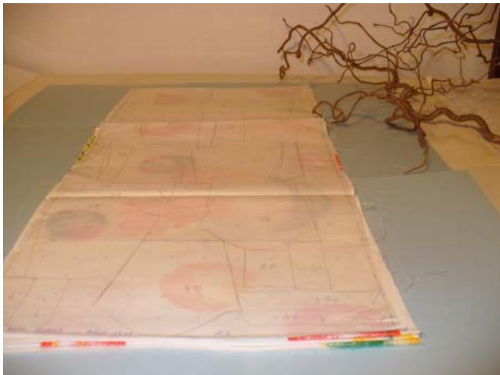
Il piazzamento è stato collocato sul materasso. Una piccola differenza fra il piazzamento e il materasso sta ad indicare che sono state rispettate le misure di sicurezza.
