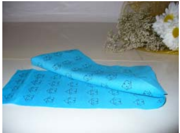
Una delle strisce è stata stesa a zig-zag. Risulta subito evidente che la stesura è scorretta per un tessuto a verso obbligato.
