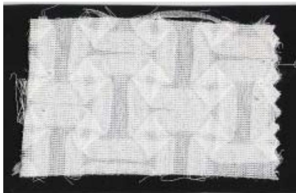
**Rovescio** - Per mantenere ferme le piegature, il tessuto è stato bloccato con un rado termoadesivo.
