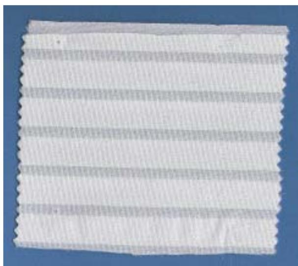
**Rovescio** - Per mantenere bloccate le pieghe, il tessuto è stato bloccato con un rado termoadesivo.
