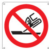
Vietato usare il disco per lisciare le superfici P032
