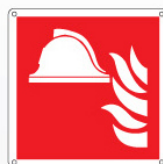
Attrezzature antincendio F004 ●
