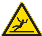
Pericolo/attenzione superficie scivolosa W011 ●
