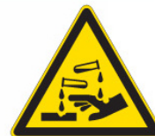
Pericolo sostanze corrosive W023 ●
