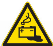
Pericolo batterie in fase di carica W026 ●
