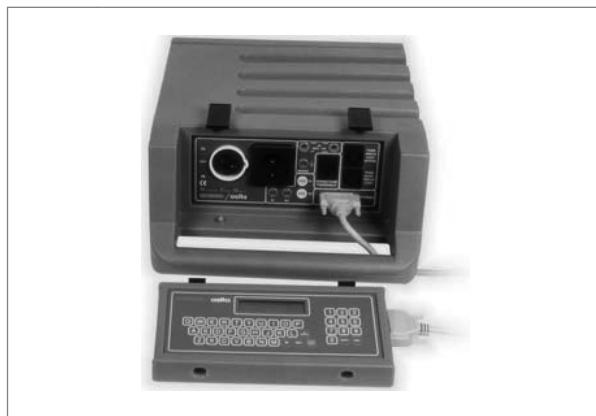
Fig. 4.4 Strumento multifunzione per prove sulle macchine e sui quadri, Mark II (ASITA).
