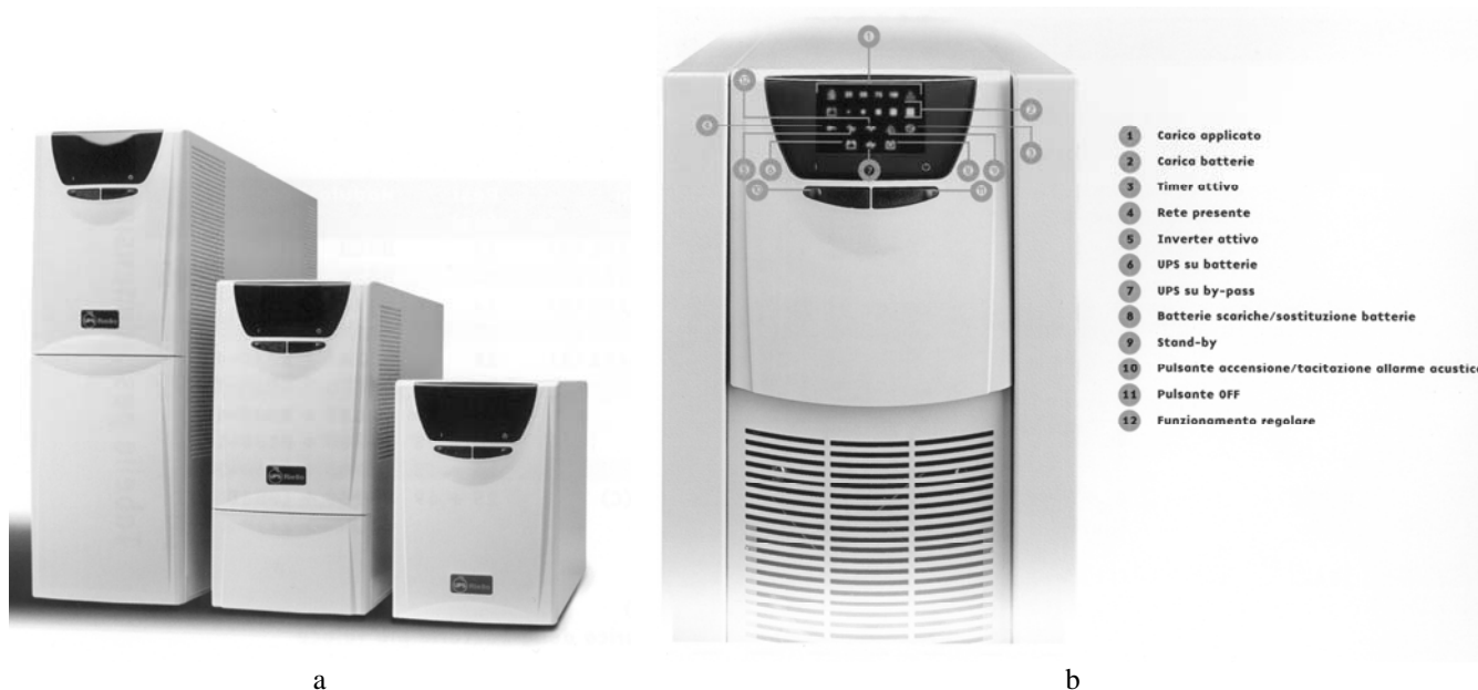
Fig. 4.206 - a) Esempi di UPS con tecnologia on-line a doppia conversione serie Dialog Plus, disponibile nei modelli 700-1000-1500-2000-3000-4000-5000 VA - b) Pannello di controllo con pulsanti di comando e diodi LED di segnalazione. Software di supervisione per PC collegato alla porta seriale RS232 (Riello).
