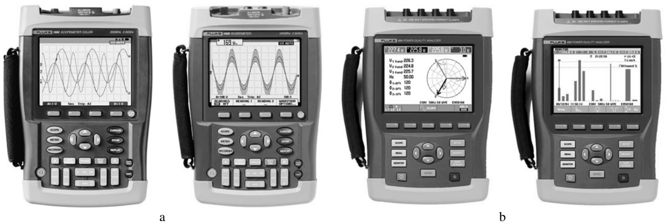
Fig. 4.203 - Esempio di strumenti palmari per la ricerca dei guasti e dei disturbi nelle reti elettriche: a) Oscilloscopio digitale portatile a colori: visualizzazione di alcune forme d'onda - b) Analizzatore di rete digitale portatile a colori: valori elettrici in un sistema trifase e misura delle componenti armoniche (FLUKE).
