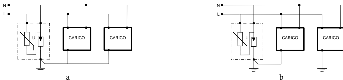
Fig. 4.195 - Equipotenzialità dei conduttori di protezione: a) Cablaggio corretto - b) Cablaggio non corretto.
