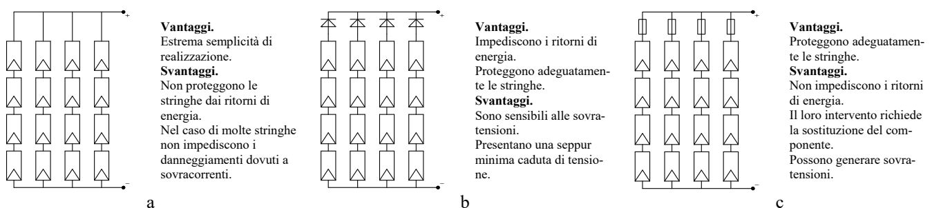
Fig. 7.32 – Tipologie di collegamento in parallelo delle stringhe: a) Parallelo semplice – b) Con diodi di blocco – c) Con fusibili.
