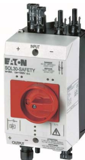
Fig. 7.33 – a) Interruttore di manovra sezionatore per impianti fotovoltaici modello P-SOL 20, I_n = 20 A, U_e = 1000 V DC – b) Interruttore di manovra sezionatore di sicurezza per sistema fotovoltaico modello SOL-30-SAFETY, I_n = 30 A, U_e = 1000 V DC (Eaton).
