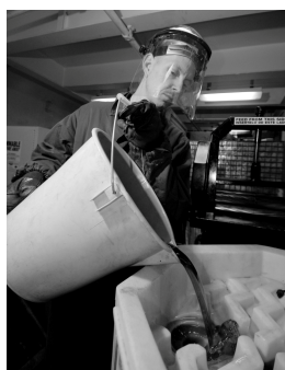
Fig. 3.16 - a) Esempio di contenitore per fluido idraulico tipo ISO VG 68 - b) Riciclaggio degli oli esausti: il fluido idraulico esausto deve essere versato in appositi contenitori per lo stoccaggio.
