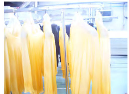
Capi di maglieria appesi durante l'asciugatura. Gli appendi abiti, sono avvolti, almeno nella parte superiore del colletto, con della carta che assorbe la nebulizzazione colorata, evitando macchie sul prodotto.
