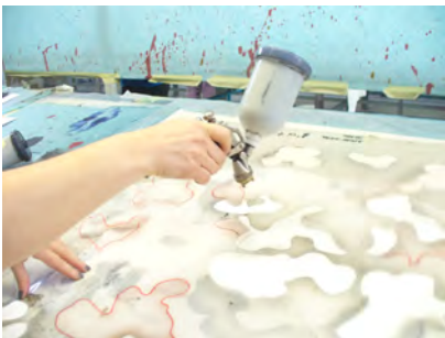
Stampa a mano, su tavolo con aerografo avvalendosi di apposite dime (o mascherine), in modo analogo alla stampa a quadri.
