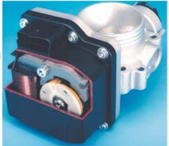
Fig. 149 - Esempi di gruppi farfalla motorizzati per l'acceleratore elettrico. A sinistra Bosch, a destra VDO.
