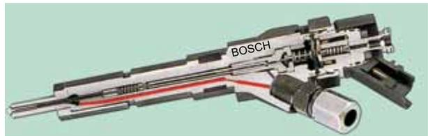
Fig. 118 - Iniettore per Common Rail di 2ª generazione (Bosch)
