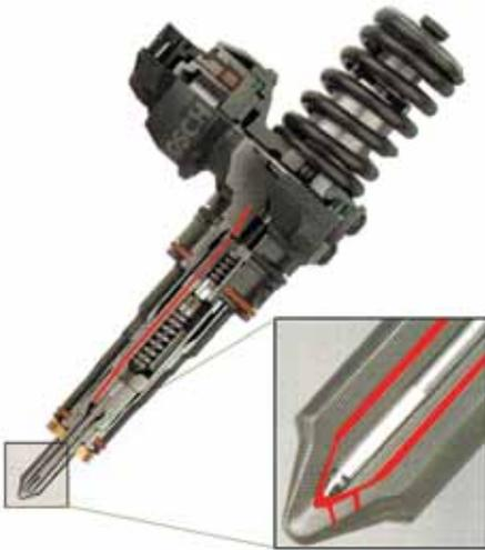
**Fig. 121** - Iniettore Vario per l'UIS della Bosch (pressione di iniezione 2050 bar). Si noti la serie di fori che si scoprono in successione.
