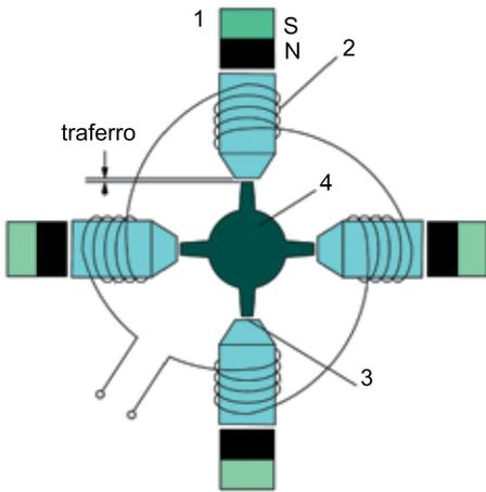
**Fig. 1** - Trasduttore induttivo (principio di funzionamento).
