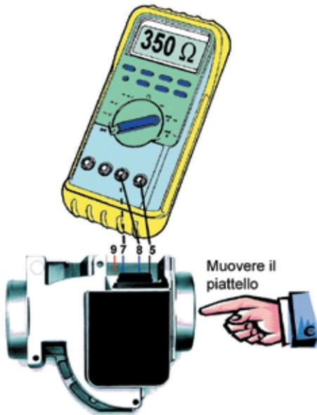
**Fig. 72** - Misura della resistenza del potenziometro contenuto nel misuratore quantità aria a piattello e del sensore di temperatura. Misura tra i morsetti 8 e 5 e tra i morsetti 7 e 5.
