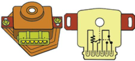
Fig. 52 - Schema interno del sensore di posizione valvola a farfalla con potenziometro, contatti di minimo e di massimo.
