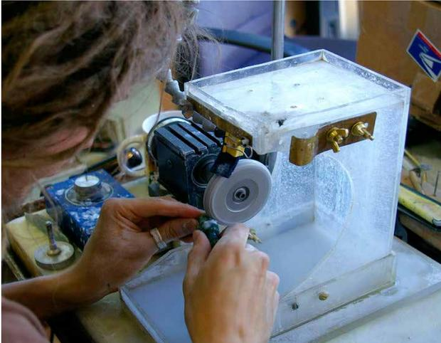
Sbozzatura del netsuke con smerigliatrice provvista di ruota abrasiva.
