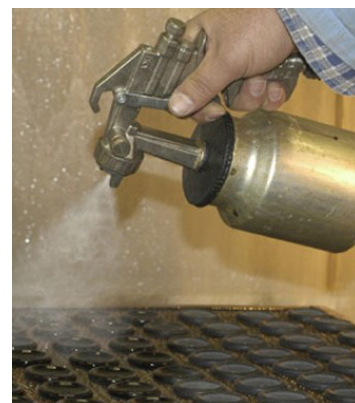
Tintura superficiale dei bottoni mediante spruzzo di colore.
