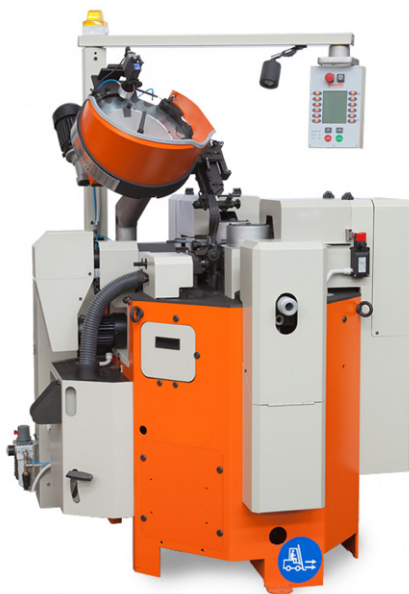
A sinistra, tornio per la lavorazione delle rondelle.
