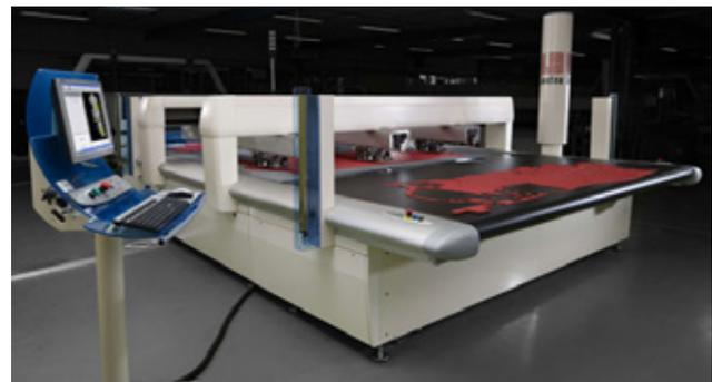
Taglio automatico delle pelli per l'abbigliamento. Permette la scansione della pelle, la rilevazione dei difetti, il piazzamento adeguato e il successivo taglio.
