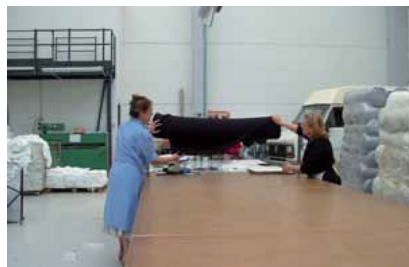
Stesura manuale del tessuto con due operatrici.
