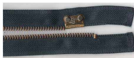
Cerniera antipanico. La parte superiore è dotata di denti a lunghezze diverse, mentre uno dei nastri è provvisto di un supporto che permette l'apertura rapida da cima a fondo senza ricorrere al cursore.
