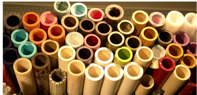
Bastoni estrusi cavi in cui verranno immesse resine con "mescolanze" di sostanze varie.
