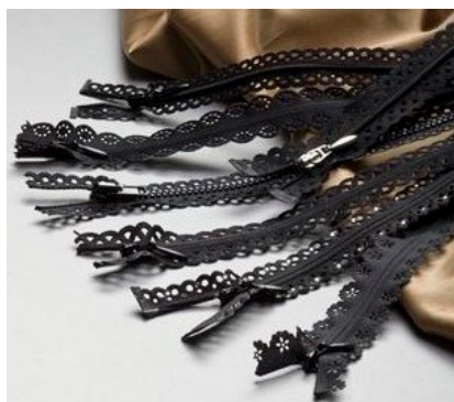
A sinistra, cerniere ad alto contenuto moda con nastri intagliati mediante laser, per ottenere motivi diversi e particolari. Sotto, catena metallica a colori diversi e sottoposta a burattatura.
