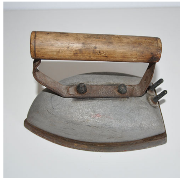
Uno dei primi ferri da stiro elettrici, senza termostato.
