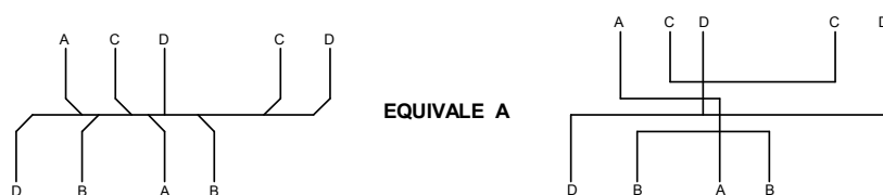
Fig. 16 - Esempio di conduttori raccolti in gruppo con linee identificate da designazioni di segnale.
