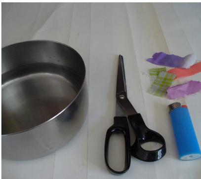
Materiali e strumenti necessari per il test di combustione: un ritaglio del tessuto da testare; forbici; un accendino; un contenitore con acqua (per sicurezza).
