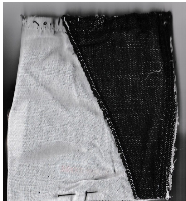
Tasca al rovescio in cui è visibile la fodera della tasca, con parte di controtasca già assemblata alla fodera.
