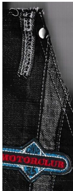
Parte del davanti con l'entrata della tasca già rifinita. Interessante anche la fermatura dei passanti sul davanti, prima del montaggio della cintura.
