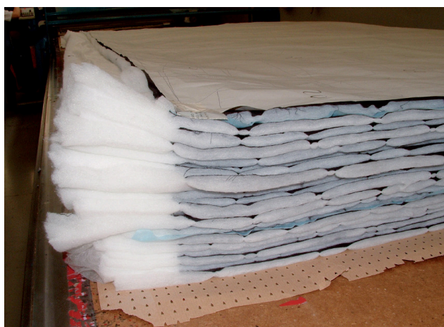
Materasso costituito da 20 strati di tessuto trapuntato alto circa 20 cm. Una volta compresso, il materasso misurerà 6-7 cm.
