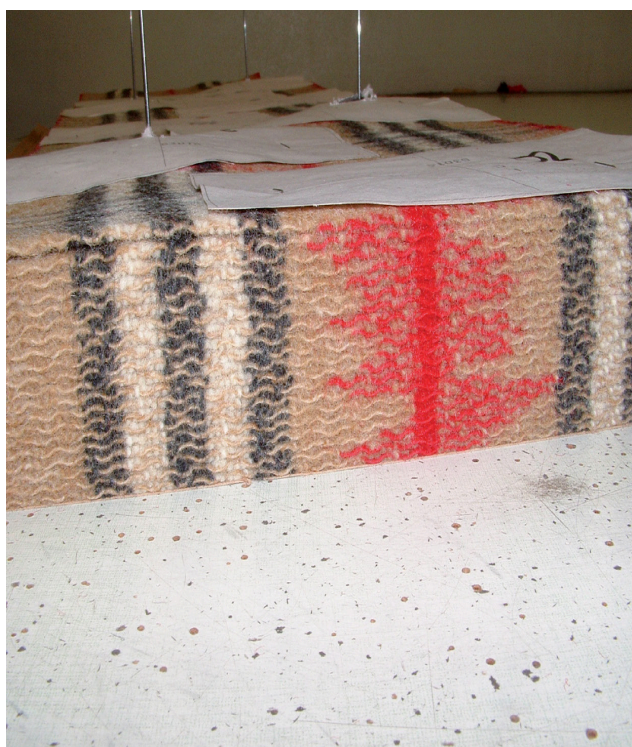
Sezione di un materasso realizzato con tessuto scozzese. Sono visibili gli strati allineati e mantenuti stabili tramite spilloni.
