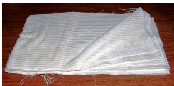
Materasso ad uso didattico realizzato con velluto a coste, steso con il diritto dentro e lo stesso verso. Il materasso creato con questa stesura, in fase di taglio manuale, è generalmente più stabile rispetto a quello prodotto mediante stesura con diritto sopra e stesso verso. In figura, si vede, infatti, che gli strati tenuti fermi da uno spillo sono slittati in misura modesta.
