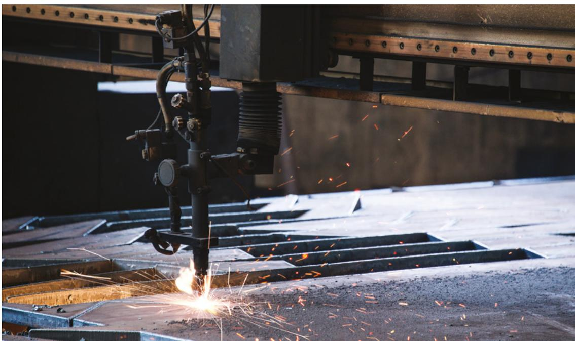
Ossitaglio eseguito mediante saldatrice industriale.
