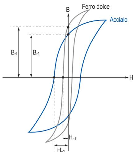
**Fig. 1.** Cicli di isteresi del ferro dolce e dell'acciaio.
