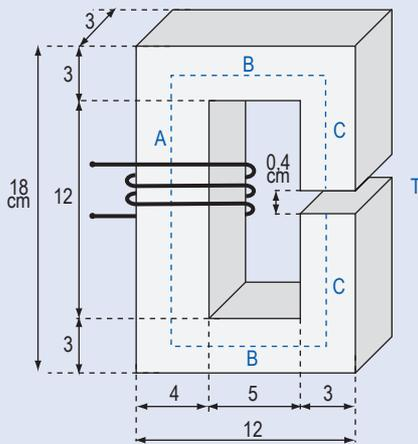
**Fig. 5.** Circuito magnetico con avvolgimento.
