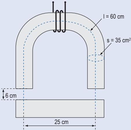
Fig. 6. Elettromagnete a ferro di cavallo.
