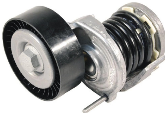
Rullo tenditore regolabile per cinghia servizi automobilistica.
