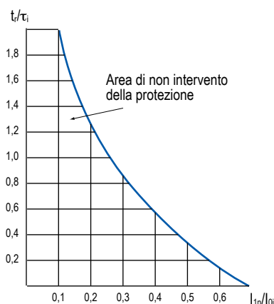
Fig. 2. Ritardo di intervento del relè di protezione.
