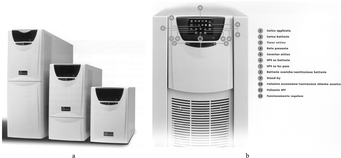
Fig. 2.206 - a) Esempi di UPS con tecnologia on-line a doppia conversione serie Dialog Plus, disponibile nei modelli 700-1000-1500-2000-3000-4000-5000 VA - b) Pannello di controllo con pulsanti di comando e diodi LED di segnalazione. Software di supervisione per PC collegato alla porta seriale RS232 (Riello).
