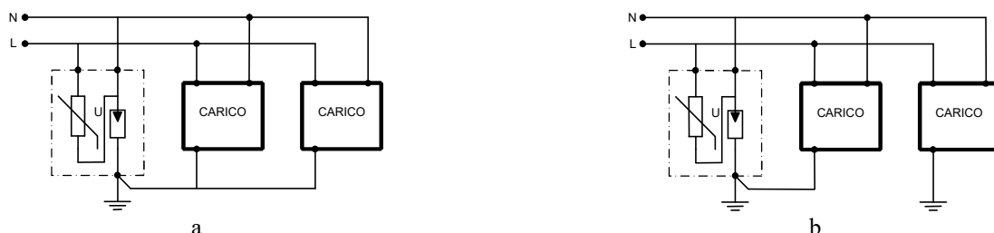
Fig. 2.195 - Equipotenzialità dei conduttori di protezione: a) Cablaggio corretto - b) Cablaggio non corretto.
