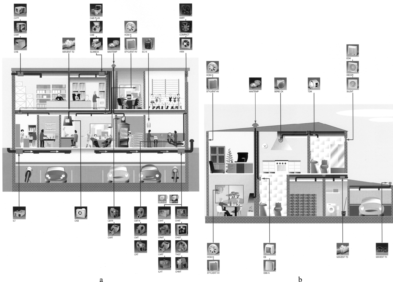
Fig. 5.134 - Esempi di applicazioni degli aspiratori: a) Nel terziario - b) Nel residenziale (Soler & Palau).
