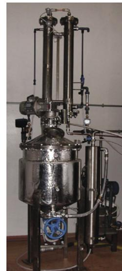
Apparecchio per la distillazione. Nel recipiente **a** c'è una soluzione (acqua e cloruro sodico). Riscaldando il recipiente, l'acqua passa allo stato di vapore; arrivato nel refrigerante **b**, si raffredda e si condensa, ritornando allo stato liquido in **c**. Il cloruro sodico rimane in **a**.
