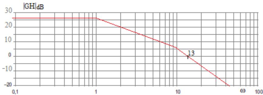
Fig. 7. Diagramma di Bode approssimato del guadagno d'anello.
