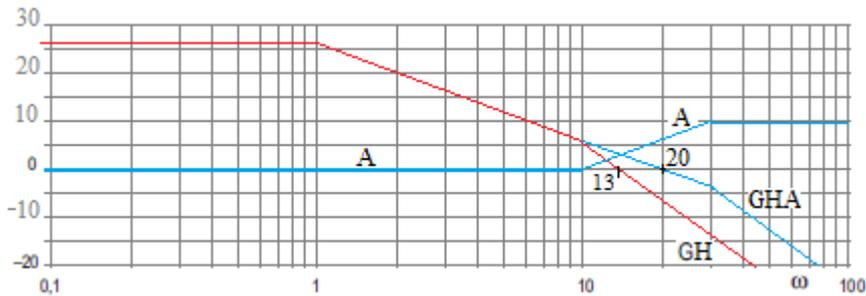
**Fig. 21.** Diagramma di Bode del guadagno d'anello GHA.
