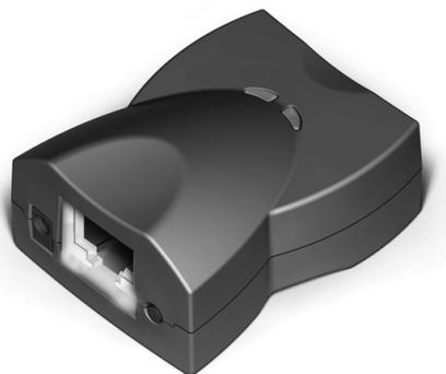
Fig. 1. Tibbo serial device server DS203.
