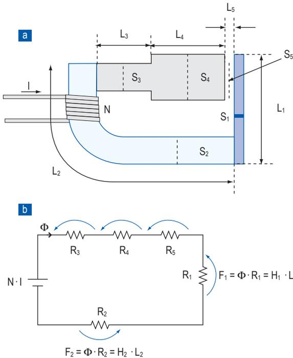
**Fig. 3.** Circuito magnetico complesso, con traferro.
