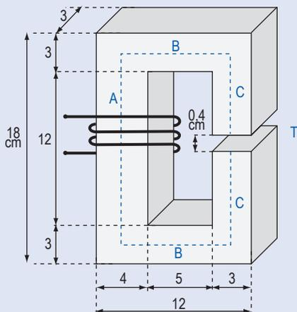
**Fig. 5.** Circuito magnetico con avvolgimento.
