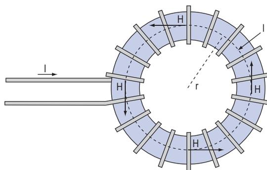
**Fig. 2.** Bobina avvolta su un anello ferromagnetico.
