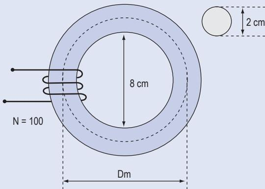
**Fig. 4.** Toroide di ferro con avvolgimento.
