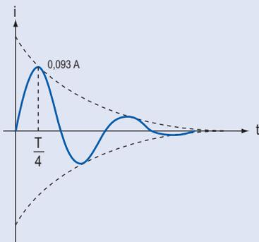
**Fig. 10.** Corrente con andamento ipercritico.
