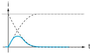
Fig. 7. Corrente con smorzamento critico.
