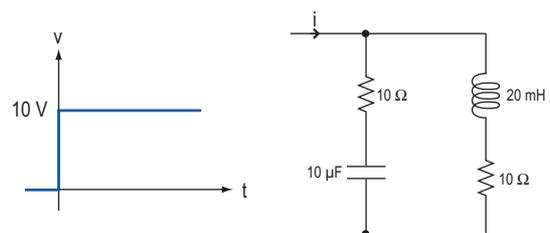
Fig. 13. Circuito parallelo sottoposto a transitorio.
