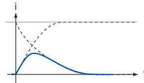
Fig. 6. Corrente con andamento ipercritico.
