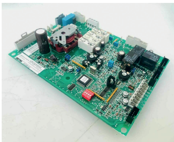
Scheda elettronica Siemens per caldaia Sime.
