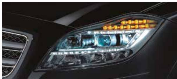
Fig. 7.31 - Esempio di gruppo ottico anteriore Full-LED (Mercedes).
