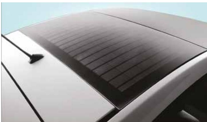
Fig. 7.37 - Pannello fotovoltaico sul tetto di una auto.
