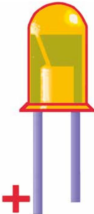
**Fig. 7.28** - LED a luce gialla.
