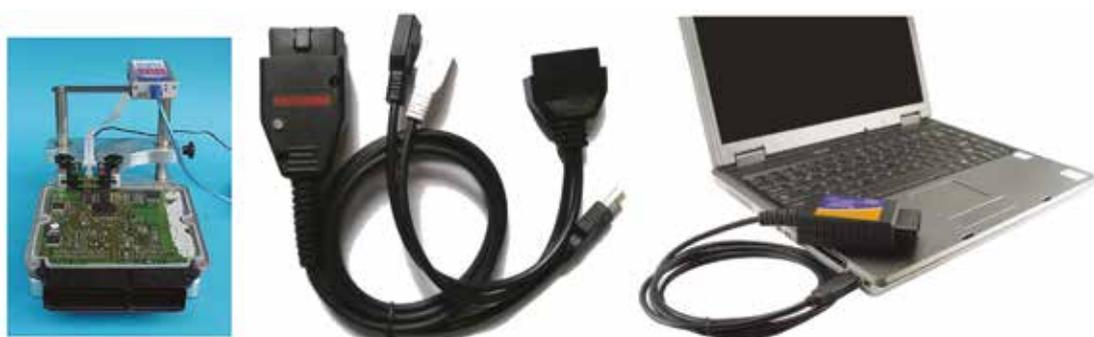
Fig. 7.81 - Attrezzatura per leggere il contenuto della EPROM. A sinistra dalla scheda, a destra tramite presa diagnosi.
