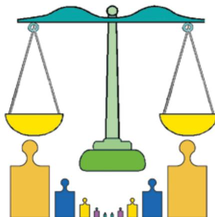
Fig. 7.75 - Per pesare con la bilancia si utilizzano dei pesi campione che si confrontano con l'oggetto da pesare finché la bilancia sta in equilibrio.
