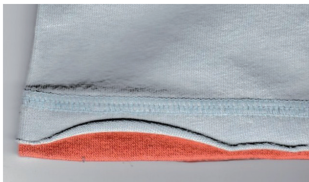
▲ Fondo di maglietta in jersey (tessuto a maglia) realizzato con taglio vivo. Si nota come il tessuto del fondo tende ad arrotolarsi; per esaltare maggiormente tale soluzione, il fondo è stato rifinito con bordino doppio a colore contrastante.
