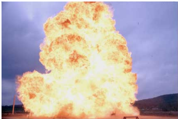
Figuur 2: Warme BLEVE van een 2 m 3 -propaantank. Ter indicatie: een spoorketelwagon is circa 80 tot 110 m 3
