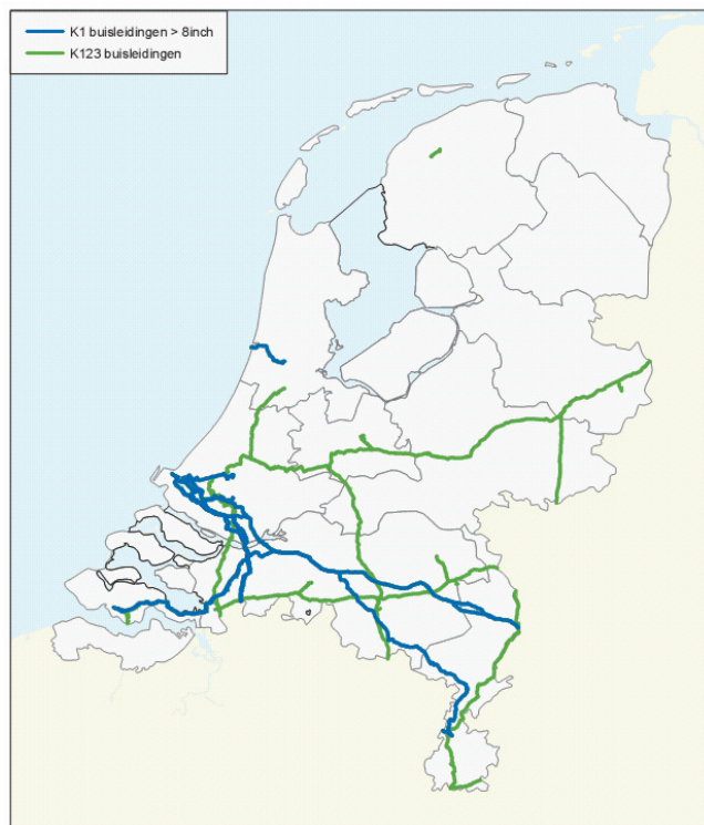
Figuur 3: Beschouwde K1, K2 en K3 buisleidingen in de analyse van de potentiële knelpunten, RIVM 2006. De leiding in Fryslân is een kerosineleiding naar de vliegbasis.
