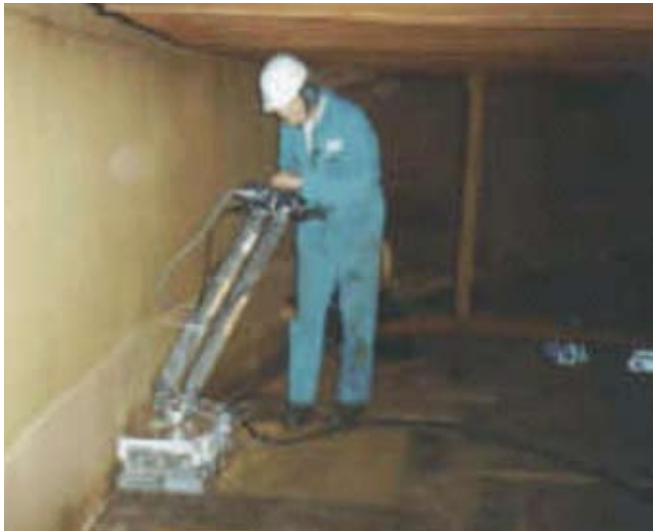
Figuur 5.3.4.2.4-3 Het SLOFEC-apparaat
