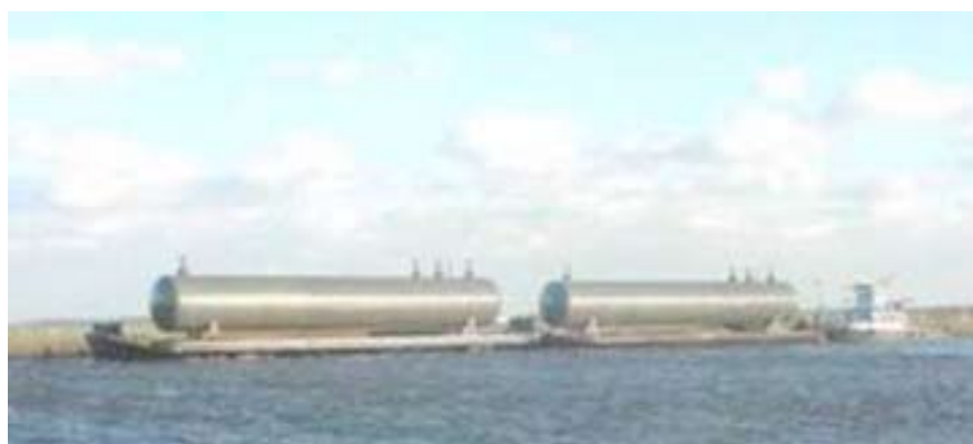
Figuur 2.1.1.4.3-3 Transport 'Mounded Storage Vessels' voor LPG na constructie
