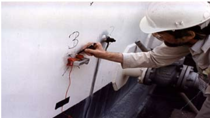
Figuur 5.3.4.2.5-2b AE-sensor op een geïsoleerde tankwand
