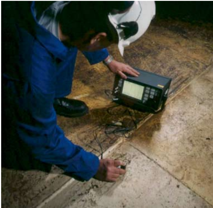
Figuur 5.3.4.2.3-3 Typische opstelling US-meting van restwanddikte
