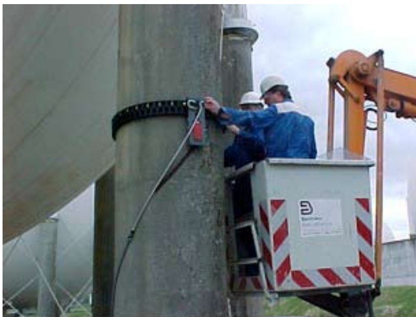
Figuur 2.1.1.4.1-9 PEC-meetopstelling ondersteuningskolommen gasspheres
