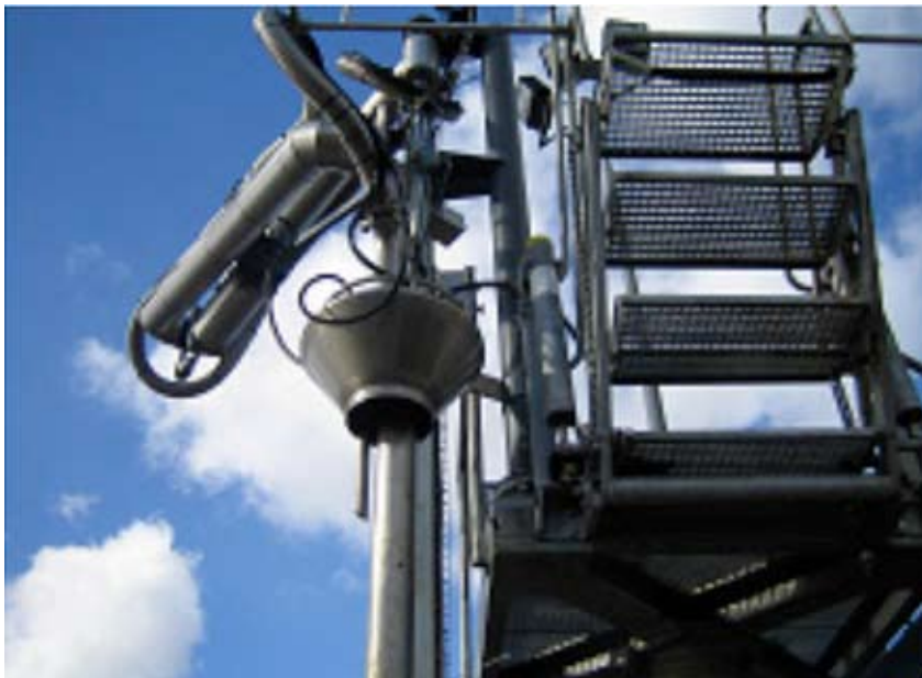
Figuur 3.3-3 Een toplaadarm in operationele situatie
