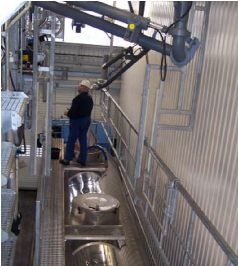
Figuur 3.5.2.3-1 Typische uitvoering verticaal bewegende veiligheidskooi
