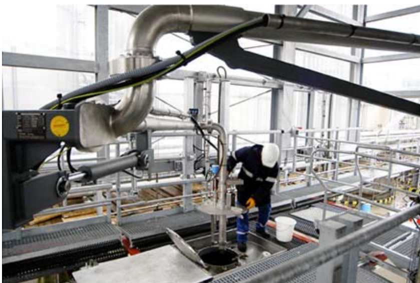
Figuur 3.3-3 Een toplaadarm in operationele situatie
