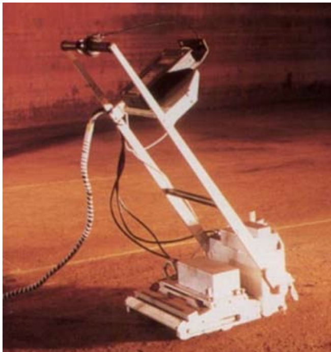
Figuur 5.3.4.2.2-2 Een voorbeeld van een MFL-meetsysteem
