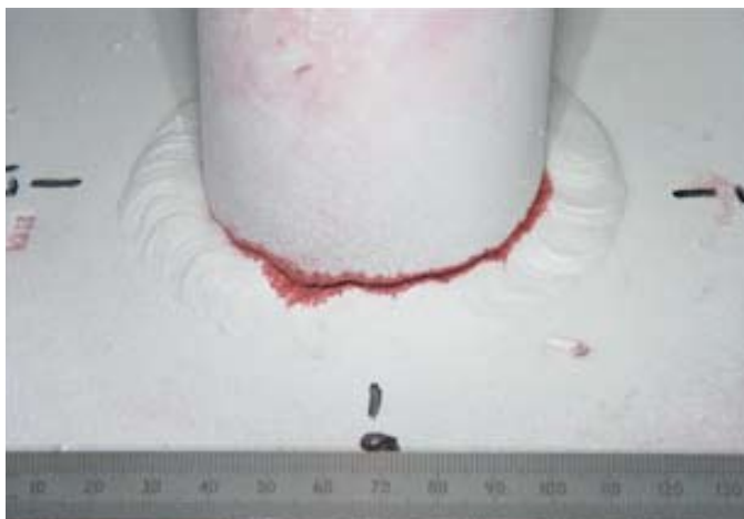
Figuur 5.3.4.4.3-1 Het uiteindelijke beeld van een lasfout na behandeling door verschillende vloeistoffen. Duidelijk is een scheur te zien in de lasnaad.
