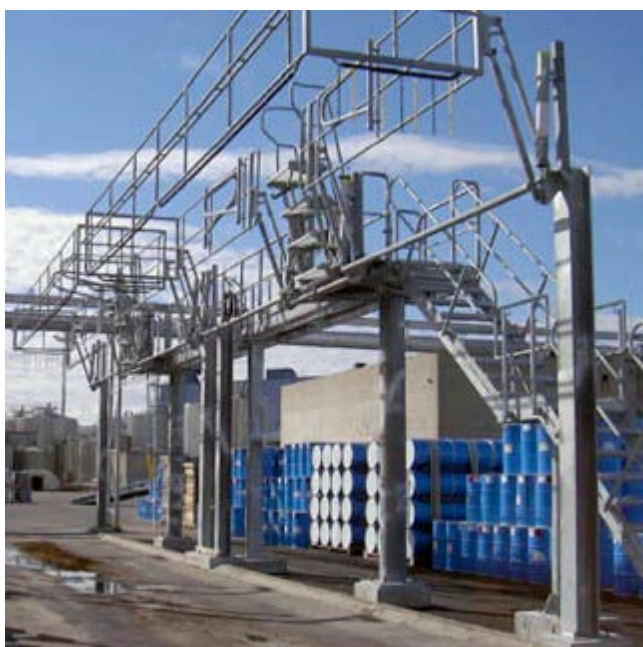
Figuur 3.5.2.2-1 Typische uitvoering veiligheidskooi
