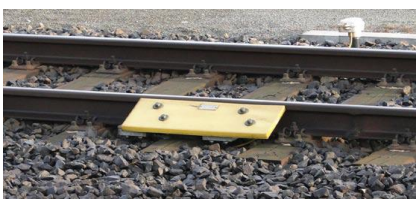
Voorbeeld van een risicoreducerende maatregel: automatische treinbeïnvloeding die treinen tot stilstand brengt die een rood sein passeren. 88
