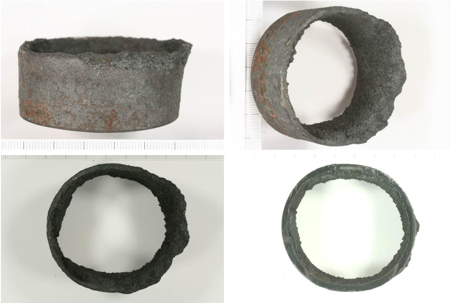
Figuur 1. Pijpstuk 3663, in zijaanzicht (linksboven), aanzicht op het breukvlak (rechtsboven, linksonder) en aanzicht op het snijvlak (rechtsonder).
