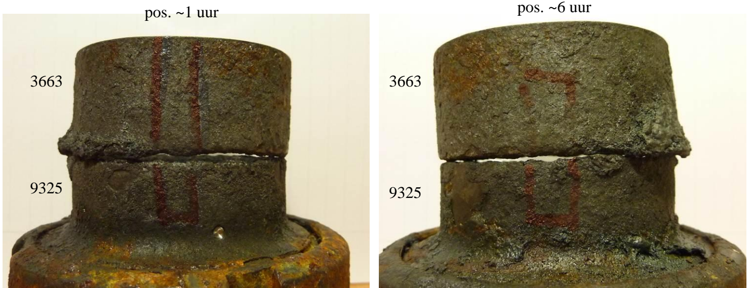
Figuur 3. De verbinding tussen pijpstuk 3663 en melkkoppeling 9325. De posities van de later geprepareerde doorsneden voor microscopisch onderzoek zijn met zwarte (donkere) stift als rechthoeken aangegeven. De posities lagen vrijwel diametraal tegenover elkaar.
