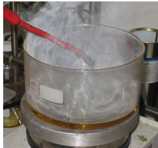
Figuur 3.2: Poging tot ontsteking van de hars door middel van 55 kV statische ontlading. Duidelijk zichtbaar is de nevel die vormt bij de heersende harstemperatuur van 200\text{ }^{\circ}\text{C} . De vlam van een aansteker was wel in staat deze nevel te ontsteken.
