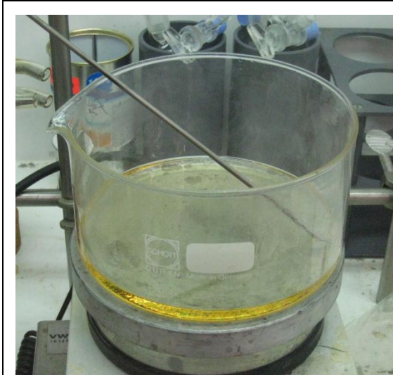
Figuur 3.1: Experiment 3.7 tijdens opwarmen, T = 180\text{ }^{\circ}\text{C} . Lichte dampvorming is zichtbaar in de kristalliseerschaal.
