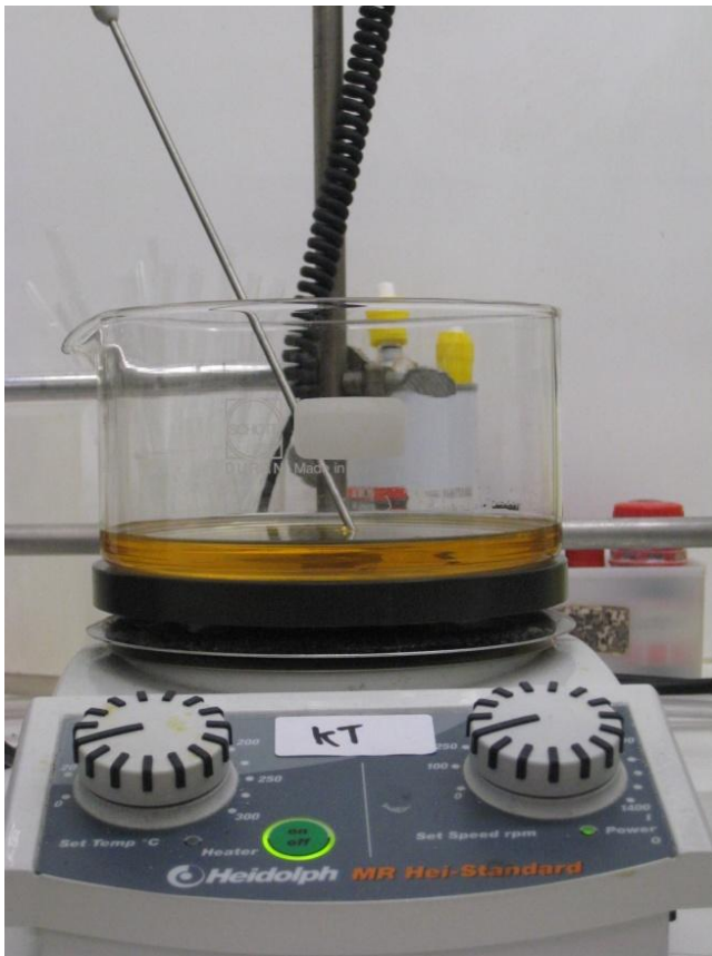
Figuur 0.1: Opstelling ontstekingstests, met externe temperatuursensor zichtbaar.
