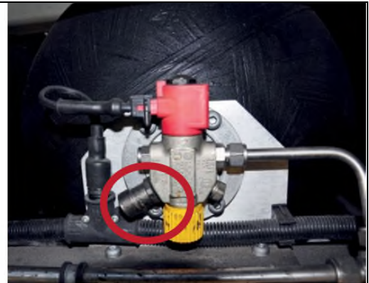
Figuur 6: De linker foto toont (rood omcirkeld) het temperatuurgevoelige afblaasventiel aan de linker zijde van de gastanks (met horizontale afblaasrichting). De rechter foto toont de gecombineerde unit aan de rechterzijde van de tanks, met (rood omkaderd) het afblaasventiel met uitstroomrichting onder een hoek van 45 graden naar beneden.
