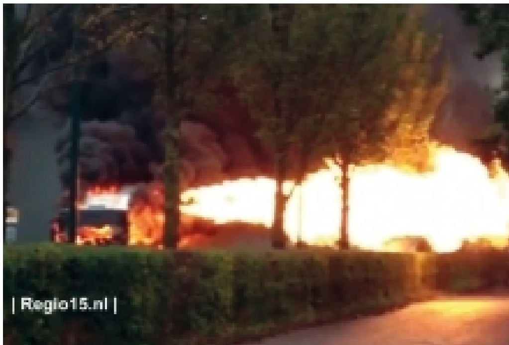
Figuur 2.1: Steekvlam bij brand CNG-bus in Wassenaar op 29 oktober 2012 (bron: www.Regio15.nl).
