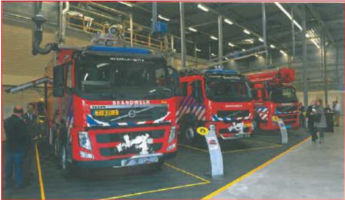
Van links naar rechts schuim blusvoertuig, industrieel interventie voertuig en hoogwerker.
