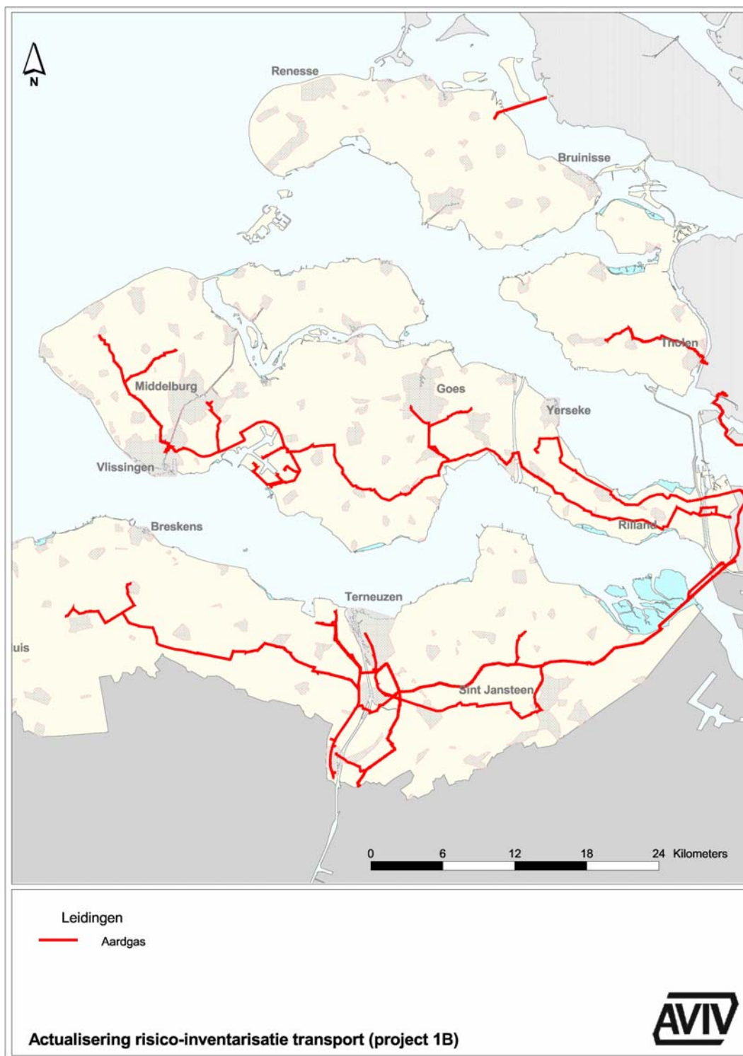
Figuur 2. Buisleidingen aardgas
