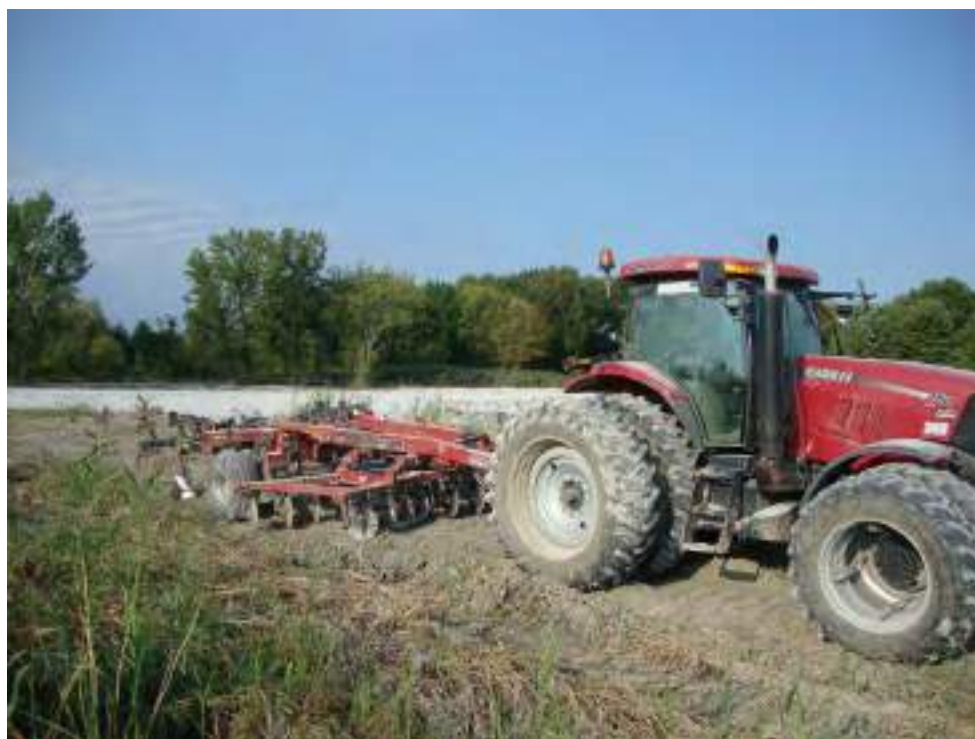
Photo 6 : Équipement utilisé pour mélanger la chaux et les sols dans les aires de traitement in-situ.
