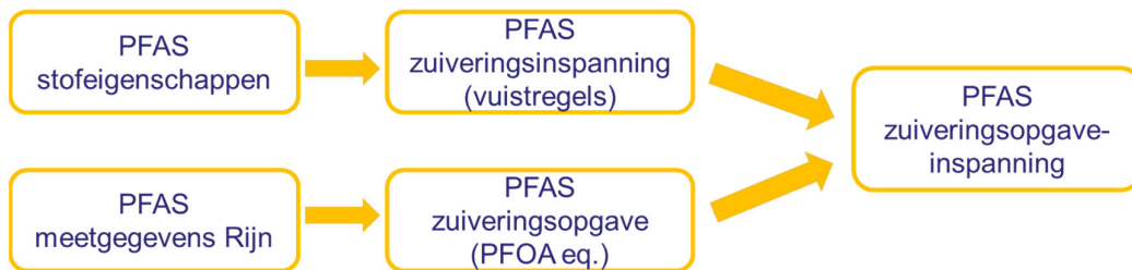
Figuur 1. De stappen om tot een uitspraak over druk van PFAS op de zuiveringsopgave-inspanning te komen.
