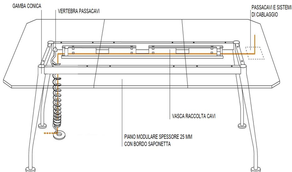
La struttura portante è composta di travi in metallo verniciato nero di sezione rettangolare 40x30 mm che si innestano alle gambe Coniche in metallo cromato o verniciate dotate di piedini regolabili sempre cromati.
