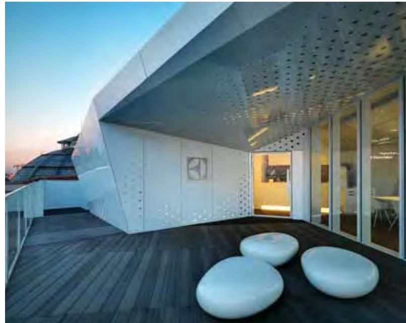
Na página ao lado, na foto, detalhe do Cubo, que pesa cerca de 30 t. Na parte externa, a “pele” metálica cortada a laser cria uma textura com desenho geométrico. Acima, à esquerda, mesa de jantar, que pode acomodar até 18 pessoas, um dos diferenciais do restaurante. À direita, imagem do restaurante também em Milão, cujo deque em balanço possibilita vista geral da cidade
