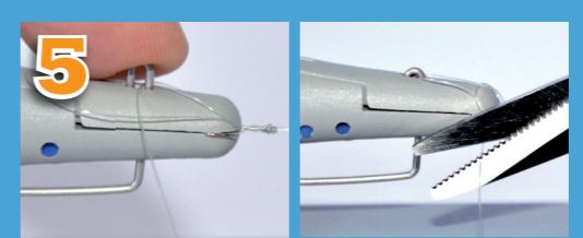
Appuyer sur la goupille. Tendre le fil et couper le brin qui dépasse. Retirer l'hameçon de l'appareil et tirer pour serrer le noeud.
