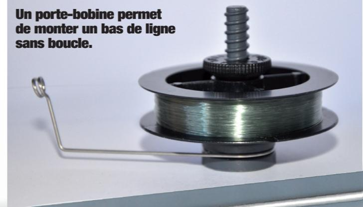
grâce à un système coulissant. Le curseur est aussi équipé d'un ressort bloque-fil si vous souhaitez monter un bas de ligne sans boucle. Il est aussi possible de réaliser le montage directement à partir d'une bobine de nylon. Elle est alors placée sur un support séparé (également fixé à la table à l'aide d'un disque métallique aimanté) à frein magnétique
